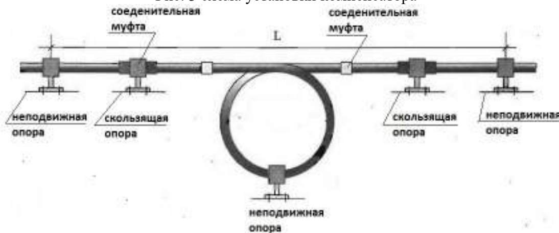
Рис. 3 схема установки компенсатора
